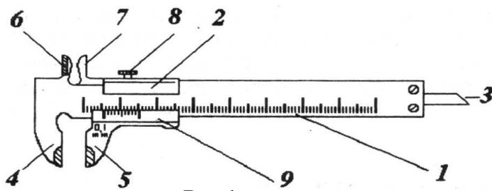
Штангенциркуль (рис.1) состоит из жесткой металлической линейки (штанги) 1 с миллиметровыми делениями
